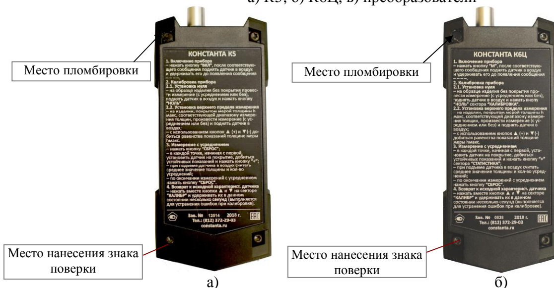
Рисунок 2 — Схема пломбировки от несанкционированного доступа, обозначение места нанесения знака поверки а) К5, б) К6Ц
